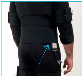
Bauchgurt anlegen und Verteiler mit Bauchgurt fixieren
