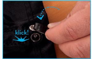
Beinanschlüsse: Rechtes und linkes langes Kabel auf schwarzen Druckknopf. Rechtes und linkes kurzes Kabel auf silbernen Druckknopf
