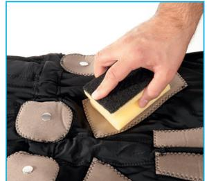
Alle Elektroden mit Schwamm befeuchten (auch die Seitenelektroden)
