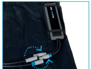
Verteileranschlusskabel anschließen, nur leicht drehen bis der Verschluss einrastet (Wichtig ist, die Farben der Anschlüsse zu beachten: Blau zu blau und grau zu grau)
