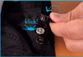
Armanschlüsse: Rechtes und linkes langes Kabel auf silbernen Druckknopf. Rechtes und linkes kurzes Kabel auf schwarzen Druckknopf
